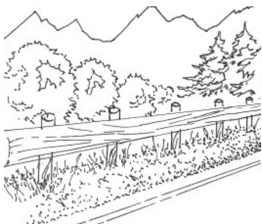
Figura 32 – Guard-rail rivestiti in legno da preferirsi in contesti montani o di particolare naturalità
